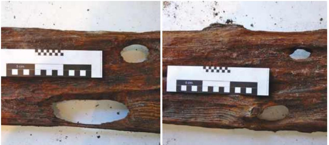
Presença de 6 orifícios de possíveis encaixes de cavilhas de madeira. Alguns orifícios são maiores possivelmente provocados pela erosão.
