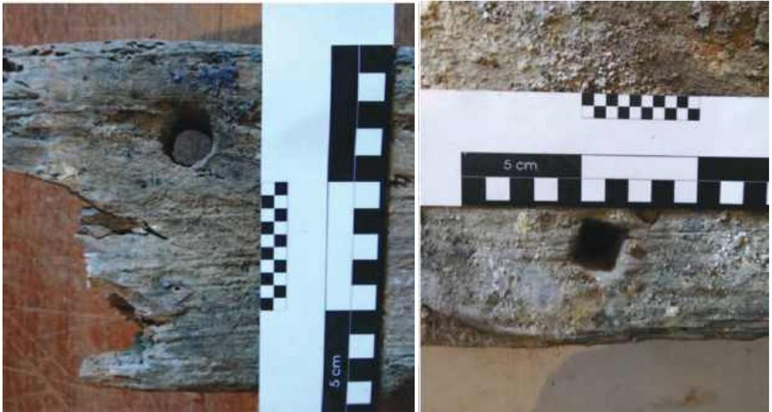
A peça é constituída por 15 orifícios de forma quadrada que vazam a peça de um lado ao outro, concluindo que sejam originados por cavilhas de metal e um orifício redondo de possível cavilha de madeira que também vaza a peça de um lado ou outro.
