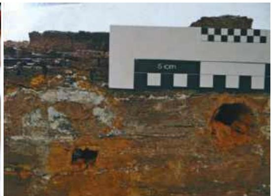
A peça é constituída por 2 orifícios redondos possivelmente originados por cavilhas redondas, onde um deles vaza a peça de um lado ao outro. Contém ainda um orifício quadrado de possível cavilha de metal.
