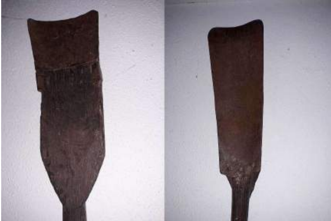
Figura 5 - Revestimento em metal das extremidades cortantes dos instrumentos de valar: O balde, à direita e pá, à esquerda. (Fonte: espólio privado do autor)
